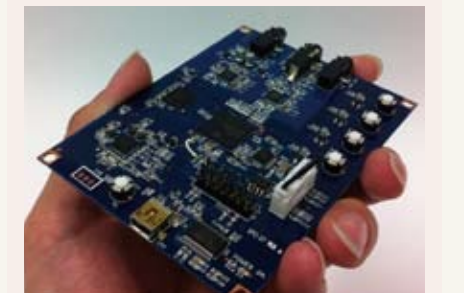
声質変換用DSP(デジタルシグナルプロセッサ) 発声障害者の声から自然性の高い声へとリアルタイムで変換するDSPの構築に取り組んでいる
